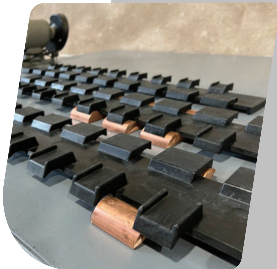
ساخت کپینگ برد پلی آمید - مجتمع مس سرچشمه
